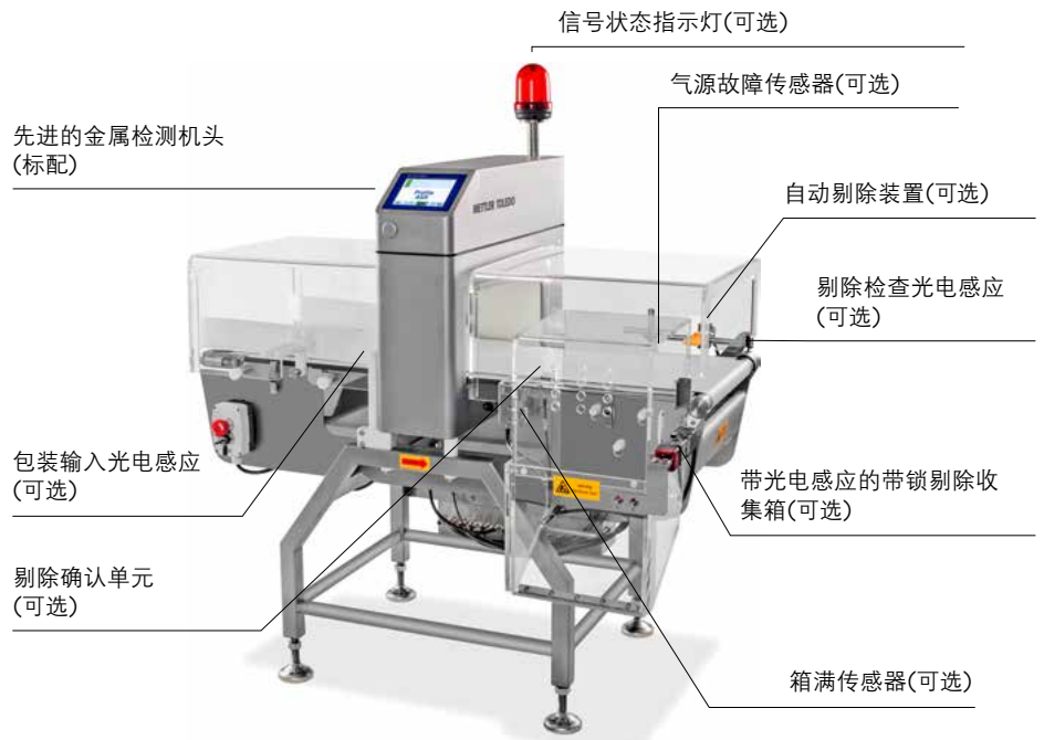
该图片展示可配选项进料和出料通道防护罩，满箱检测辅助装置，剔除确认辅助装置和信号状态指示灯
